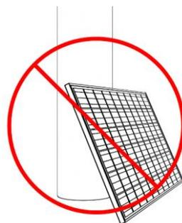
4.2.7 Wenn nach dem Auspacken NICHT alle Module entfernt wurden und einige im Paket verbleiben, sind die verbliebenen Module flach hinzulegen und erneut zu verpacken, damit sie nicht umfallen. Sie sind horizontal abzulegen.
